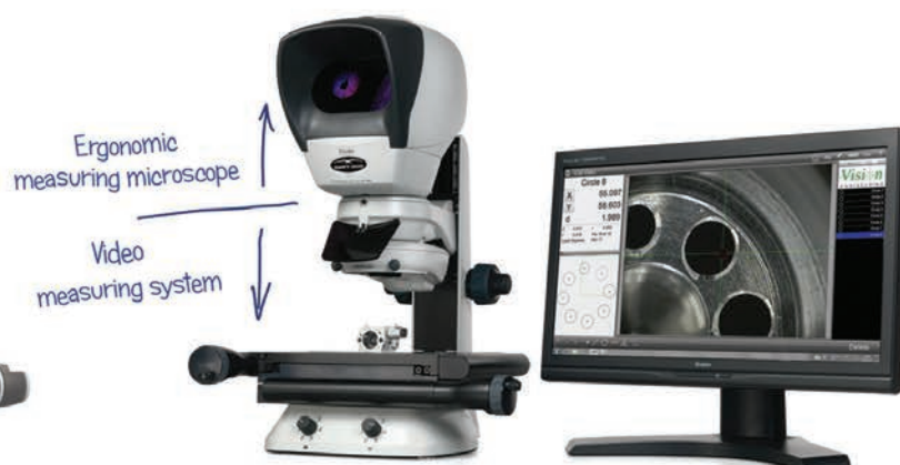
Óptica doble swift-Duo y sistema de medición en video.
