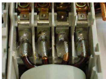
Soldadura de 4 terminales de una bobina
