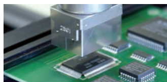
El ajuste de altura con STOP mecánico permite un proceso rápido y repetitivo.
