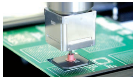
ST 350 sujetando componente BGA.
