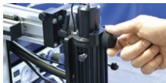
ST 350 sujetando componente QFP.
