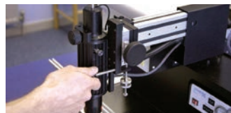
Alinear BGAs es fácil con el método de alineación por plantilla.
