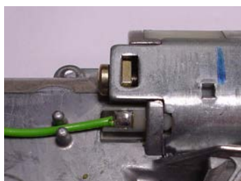
Soldadura de un cable en un terminal
