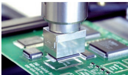
ST 350 sujetando componente QFP.
