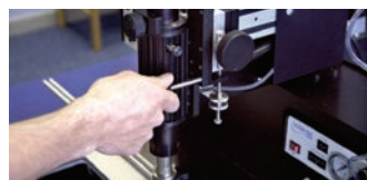
El cabezal se mueve de manera que el acceso sea óptimo a la placa para limpiarla y prepararla.
