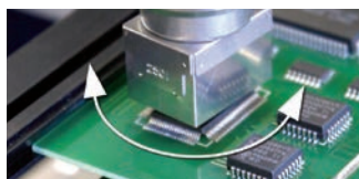
Característica única PACE. El simple ajuste de coplanaridad permite ajustar mejor el cabezal que en los sistemas fijos.
